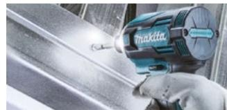
Colocación de tornillos autopercutores en metal delgado como perfilaría.
